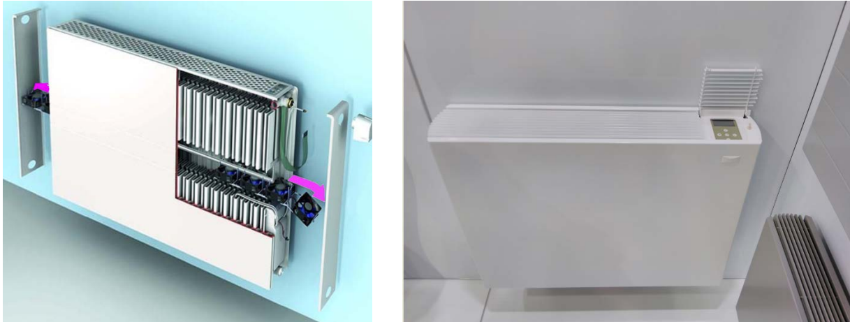
Ventilatorradiator voor LTV, waarmee zowel verwarming als koeling mogelijk is. De exploded view links toont de inbouw-ventilatoren, die snel te vervangen zijn (paarse pijlen). Rechts de ventilerende radiator zoals in de handel. Beeld: © ejn en Radson.
